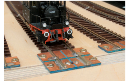
Der Gleisübergang von Schwenkbühne auf Modulkopfstück. Die Kupferkaschierung muss in der Mitte aufgetrennt werden.
